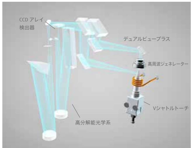
Vシャトルトーチ、高周波ジェネレーター、デュアルビュープラス、高分解能光学系を含むPlasmaQuant 9100の主要コンポーネント図
